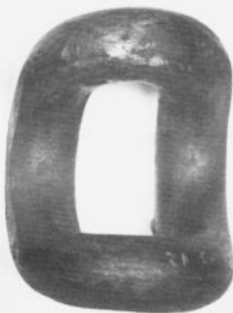
Slika 3. Upogibna proba gašene verige \phi 13 mm. Včasih na členih napravimo rastersko razdelitev in ugotovljamo lokalni raztežek na natezni strani upogibnega člena.
