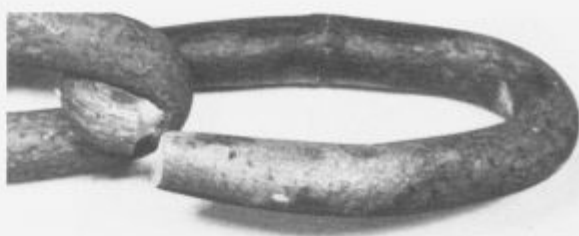
Slika 1. Sila trganja in kontrakcije sta presegle predpisano vrednost. Veriga je bila gašena s 1050°C v vodi.
