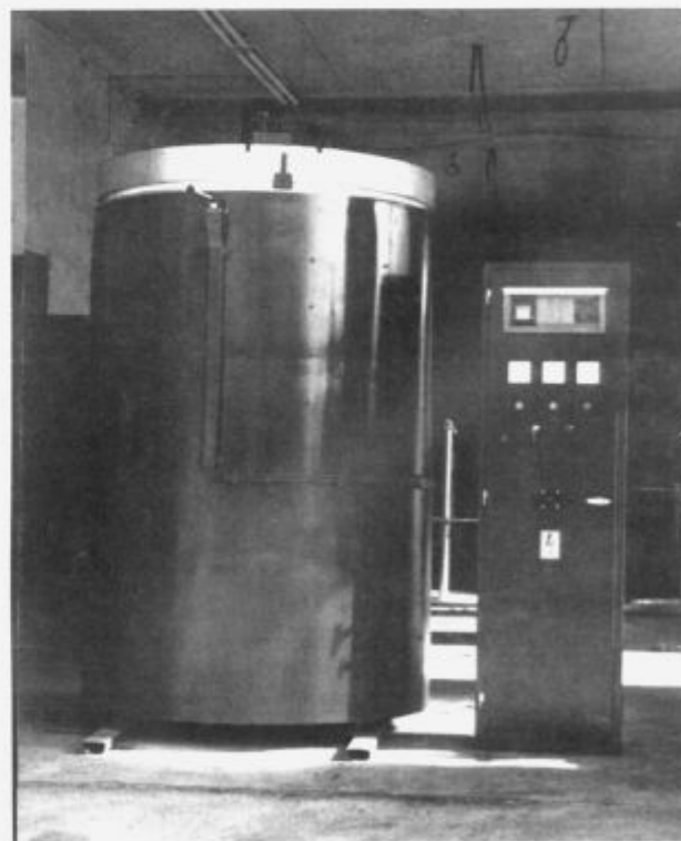
Slika 5. Elektro jaškasta peč za napetostno popušcanje Figure 5. Electric shaft furnace for stress relieving
