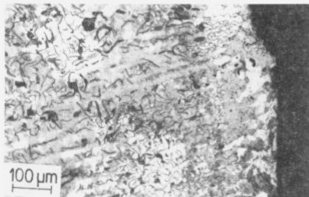
Slika 7: Mikrostruktura z RB 25 cepljene litine (palica s premerom 30 mm); trajanje odstajanja po cepljenju: 15 minut
