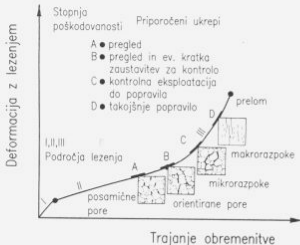
Slika 1: Poškodbe v jeklu v odvisnosti od trajanja deformacije z lezenjem 1
