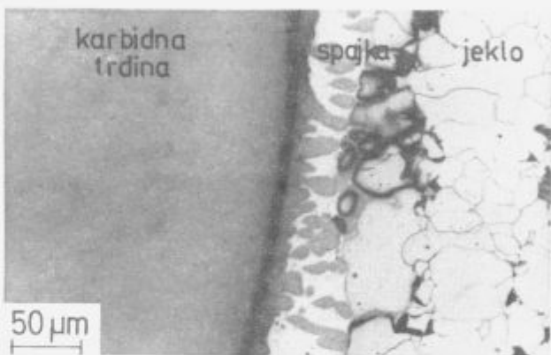
Slika 5: Mikrostrukture spoja zrno karbidne trdine/konstrukcijsko jeklo na tujem vzorcu brusne plošče
