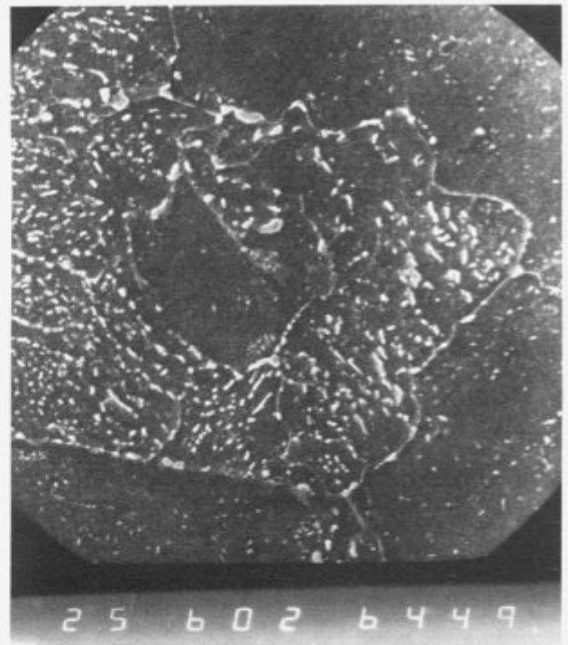
Slika 4: Mikrostruktura jekla 10CrMo 910 slikana s SEM - cev v izhodnem stanju (6000 x)
