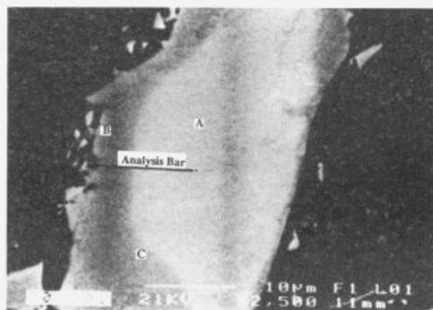
Slika 4: SEM (BSI) posnetek delno nitriranega prahu (90 min.) ki prikazuje neuniformno rast nitridne plasti. Marker prikazuje področje mikroanalize, ki je prikazano na sliki 5. (n.b.: centralna osenčena črta je artefakt BSE detektorja)
