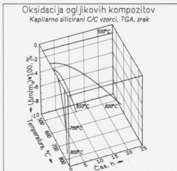
Slika 2: Hitrost oksidacije ogljikovih kompozitov na zraku pri temperaturah nad 500°C strmo narašča
