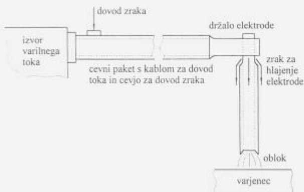
Slika 9: Shematski prikaz varilne naprave za ročno varjenje z oplaščeno elektrodo z dodatnim hlajenjem držala elektrode in oplaščene elektrode
