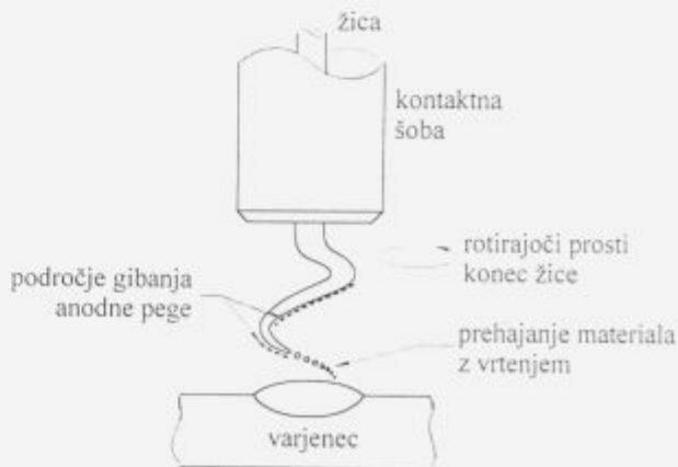
Slika 2: Shematski prikaz prehajanja materiala z vrtenjem in gibanje anodne pege po površini rotirajočega prostega konca žice
