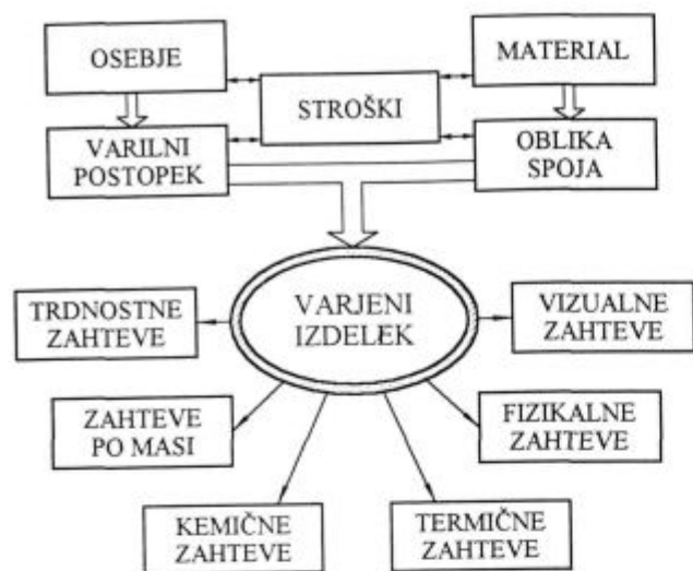
Slika 1: Splošne zahteve, ki jih morajo izpolnjevati zvarjeni spoji med eksploatacijo oziroma uporabo
