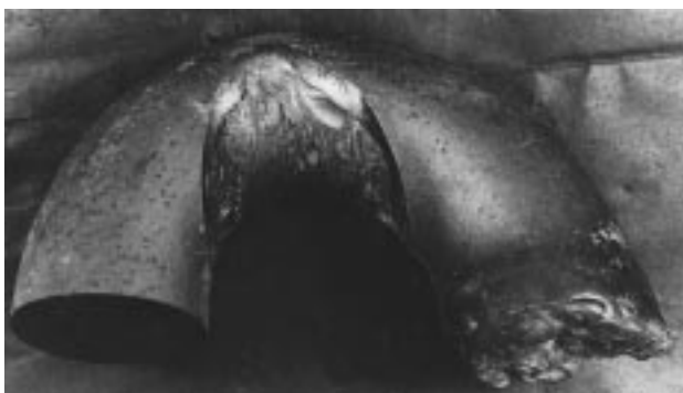
Slika 2: Obrabljena notranja povr{ina -lena verige Figure 2: Worn internal link surface
