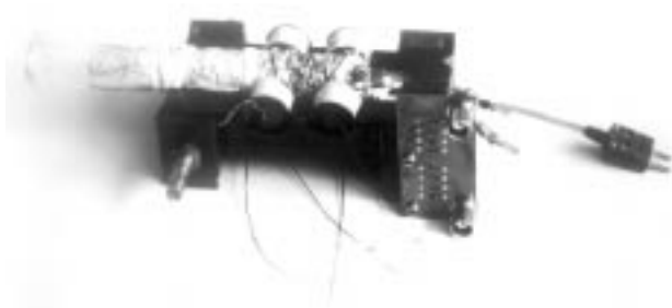
Slika 2: Grelnik, navit na epruveto, obdan s toplotno izolacijo, v hladilnem bloku iz bakra, priklju-ki za grelec, termoelement, merilni signal in dovod hladilne vode
