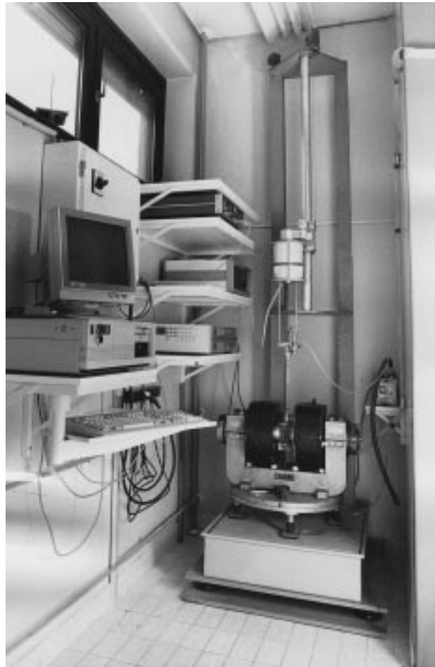
Slika 4: Vzorec je pritrjen na konec palice, ki jo treso elektromehanski pretvornik, in le'i v homogenem polju elektromagneta. Na desni strani je pripravljena rotacijska -rpalka za evakuiranje epruvete z vzorcem
