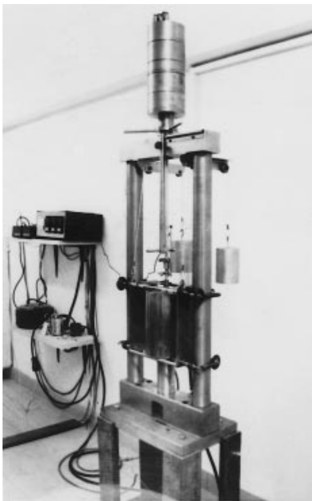
Slika 1. Preskusna naprava z majhnim batom v laboratoriju za lezenje na IMT v Ljubljani Figure 1. Small Punch testing equipment in the creep laboratory at the IMT Ljubljana
