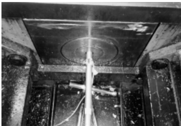
Slika 2: Merjenje sile vlečenja Figure 2: Measurements of drawing force
