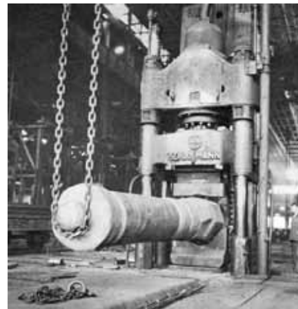
Figure 12: Heavy forging piece on the 18.5 MN press Slika 12: Težak odkovek na preši 18,5 MN
