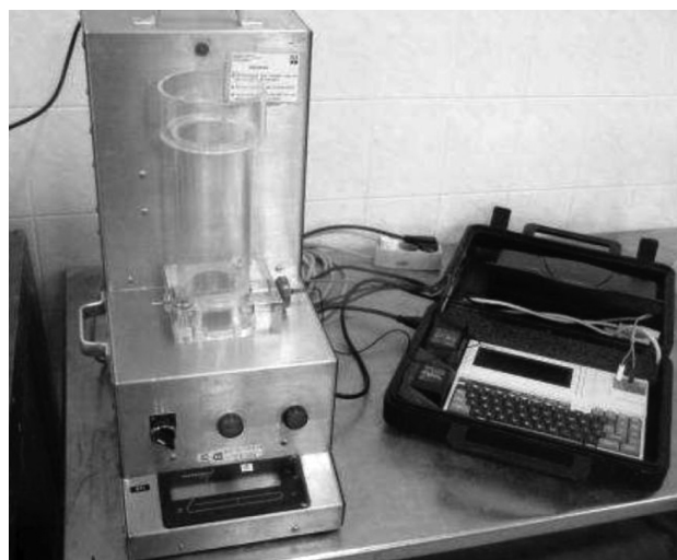
Figure 3: Air Void Analyzer (AVA) Slika 3: Analizator praznin (AVA)
