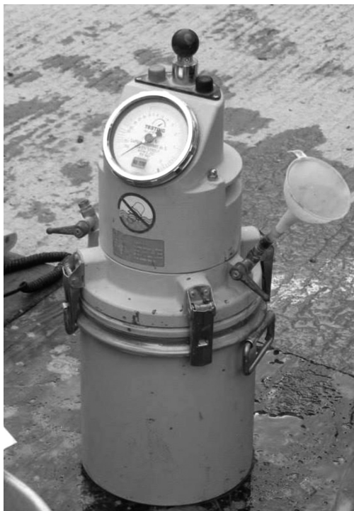
Figure 2: Concrete pressure-air meter Slika 2: Merilnik tlaka zraka v betonu
