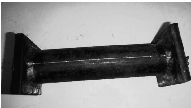
Figure 5: The sample drilled for axial residual stress measurement and hydrostatic tests Slika 5: Zvrtan vzorec za merjenje aksialnih zaostalnih napetosti in hidrostatični preizkus
