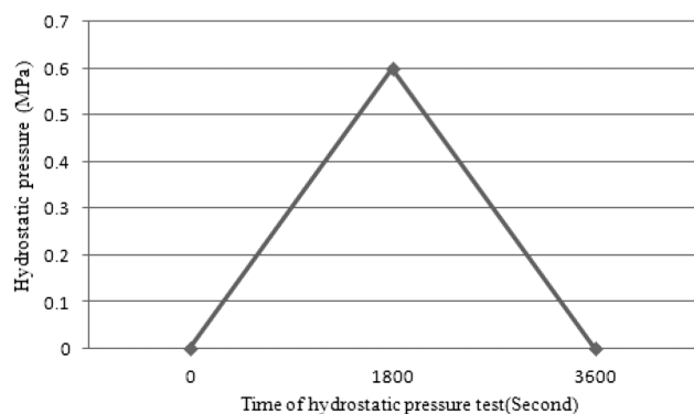
Figure 6: Applied hydrostatic pressure as a function of time Slika 6: Uporabljen hidrostatični tlak v odvisnosti od časa
