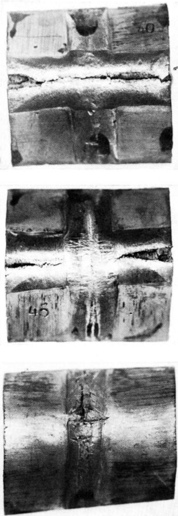
Slika 3 Neobstojnost proti interkristalni koroziji
