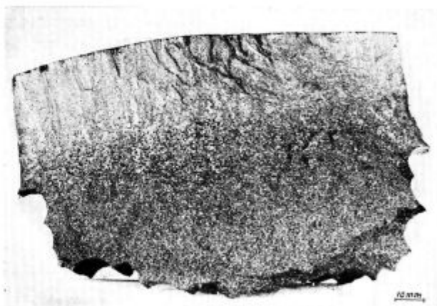
Slika 2 Trda zunanja plast in prehodna cona valja iz trde litine
