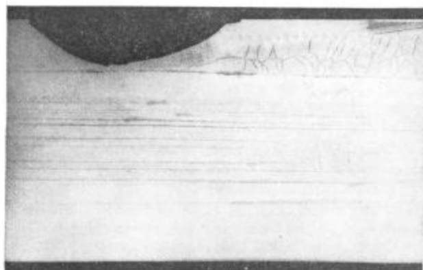
Slika 6 Brusilne razpoke na rezini
