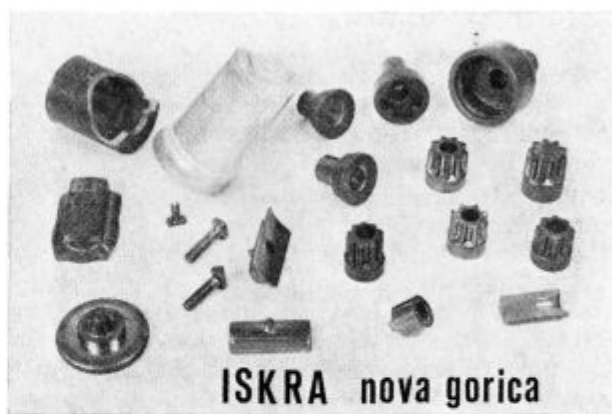
Slika 11 Izbor hladnih stiskancev Fig. 11 Selection of cold formed parts
