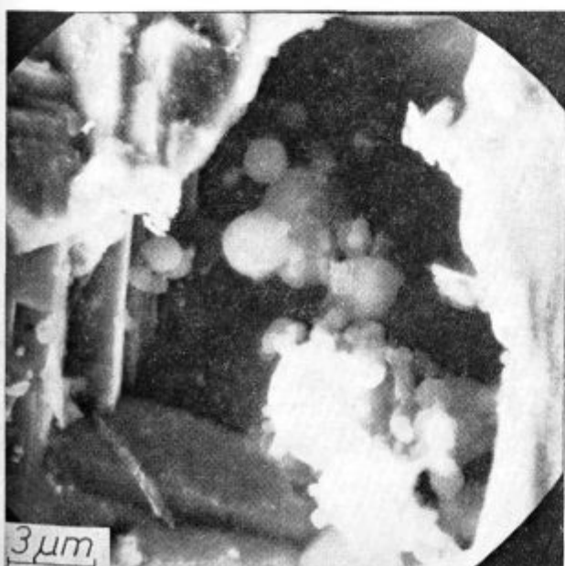
Slika 3, 4, 5, 6 in 7 Posnetki krogličastih vključkov aluminijevega oksida v raster mikroskopu.
