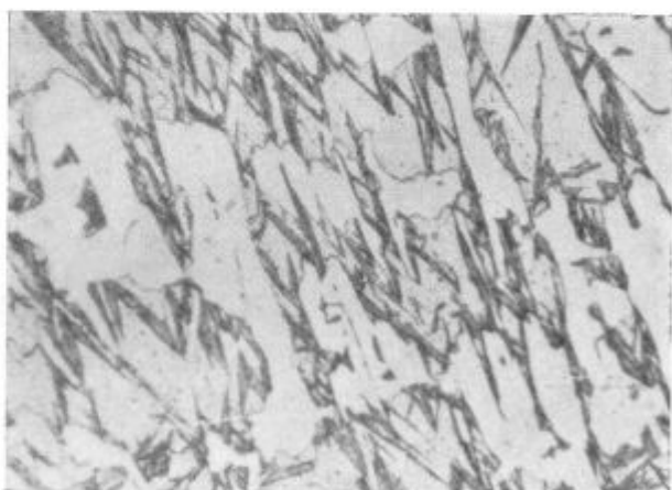
Slika 5 Metalografska struktura nežarjenega kokilnega vzorca v globini 15 mm — povečava 630 ×, nital Fig. 5 Metallographic structure of not annealed mould-cast sample 15 mm below the surface. Magnification 630 ×, Nital
