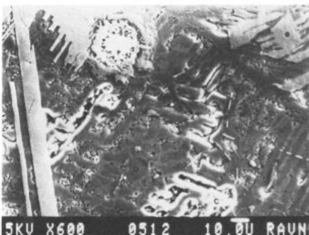
Slika 6 Mikrostruktura žilindre, 600 × Fig. 6 Microstructure of slag, magn. 600 ×.
