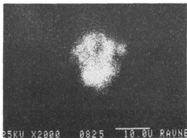
Slika 14 Porazdelitev Al K \alpha , pov. 2000 \times Fig. 14 Distribution of Al K \alpha , magn. 2000 \times .
